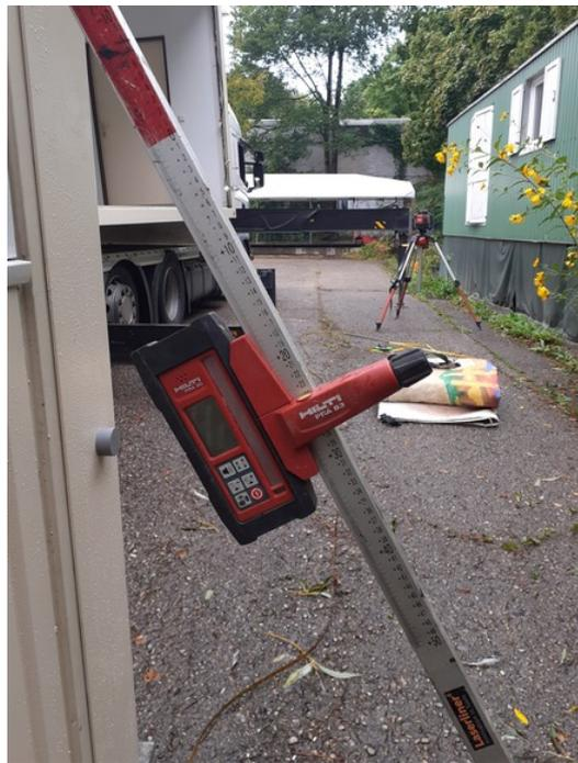
Ausgemessen mit Lasern wird der Platz millimetergenau vorbereitet.
